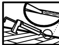
Después de instalar los tablonos y antes de instalar las molduras, elimine todos los espaciadores. Cree un espaciado a prueba de filtración con una varilla de respaldo de espuma PE de 10 mm (3/8") y un sellador flexible 100 % de silicona en todo el perímetro de la habitación y alrededor de objetos fijos y molduras de transición. No use un sellador acrílico.
